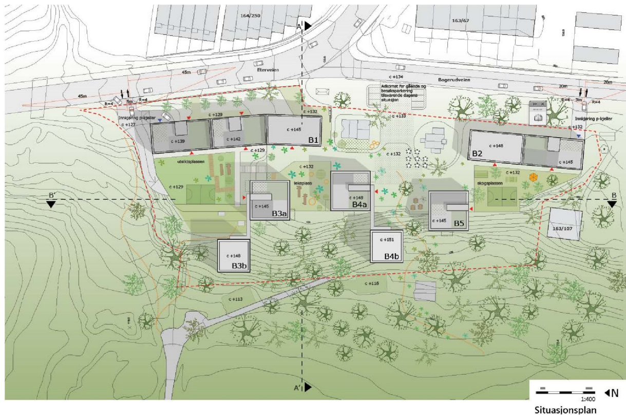
1.1 Utsnitt fra situasjonsplan VISER Lameller mot Eterveien og Bogerudveien i øst mellom 3-5 etasjer Punkthus på mellom 4-9 etasjer som "tåm" volumer mot syd og vest
