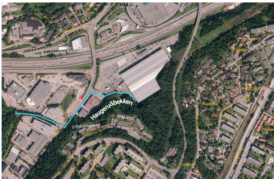
Alternativ 5: Trase for Haugerudbekken langs Smalvollveien.
