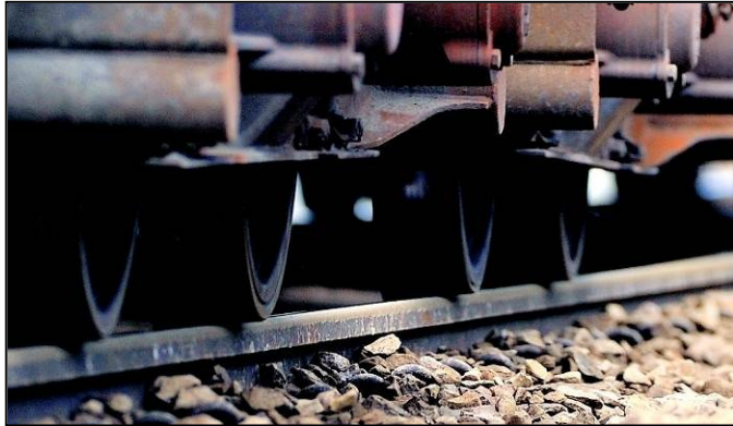
KONTAKTFLATE HJUL OG SKINNE. FOTO: ØYSTEIN GRUE
