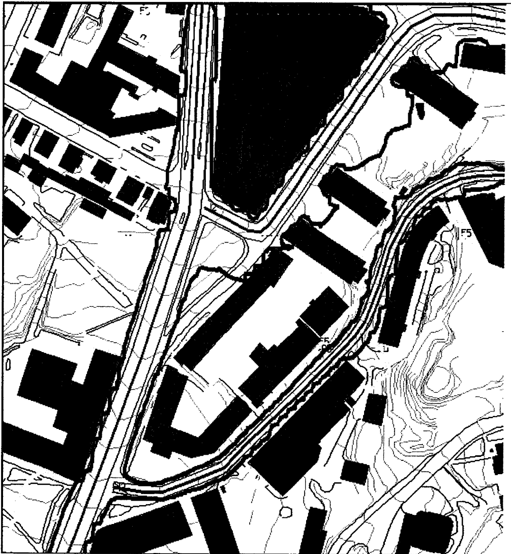
Figur 3-3: Beregning av L_{DEN} ved utbygging i syd. Beregnet 2m over mark, typisk støynivå på uteplass. Gul støykote = L_{DEN} = 55 dB, Rød støykote = L_{DEN} = 65 dB. Støy fra alle veier lilla linjer, trafikksituasjon 2018.
