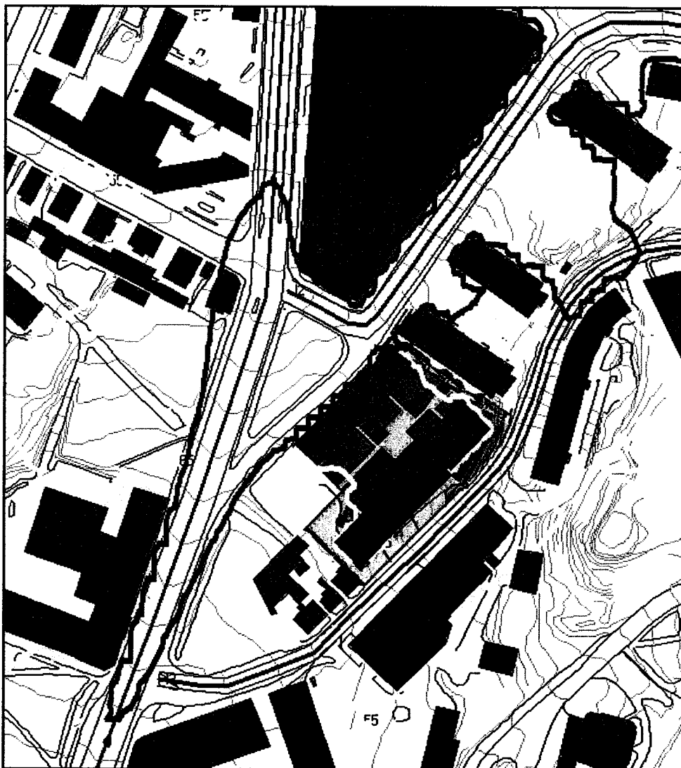
Figur 3-2: Støykoter for bolignivå 4 og 5, dvs. høyde ca. 11-13 m over mark. Det er små forskjeller i nivå i de øverste etasjene. For mer nøyaktige punktregninger, se vedlegg A.
